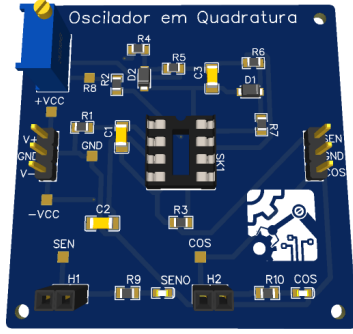
Figura 6. Placa de circuito impresso do oscilador de quadratura, com dimensões de 50x50 mm. A placa possui conectores para as saídas v_{sen} e v_{cos} que serão usadas para acoplamento, além de conectores para alimentação. No canto superior esquerdo da placa está o potenciômetro R_{V1} para ajuste de frequência.
