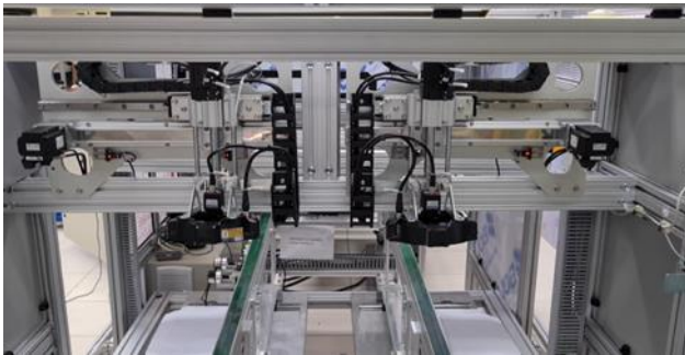
Fig. 7 Montagem: Interna do mecanismo de suporte de câmeras.
