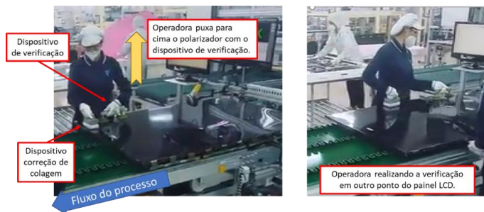
Fig. 2 Processo Atual: Processo de Fixação e Verificação do Filtro Polarizador Manual.
