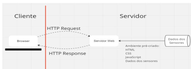
Fig. 8. Arquitetura de funcionamento do protocolo HTTP.
