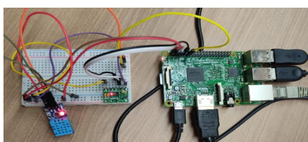
Fig. 10. Prototipação eletrônica das vinculações dos sensores e a unidade de processamento.
