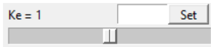
Figura 3. Controle deslizante que altera o K_e da ferramenta interativa do controlador PI com ação anti-windup . É possível alterar o valor da variável deslizando o controlador ou escrevendo um valor na caixa de texto e clicando no botão “Set”
