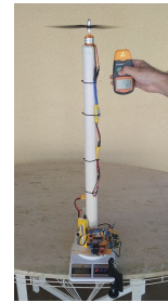
Figura 2. Ensaio para obtenção da força da hélice em função de RPM
