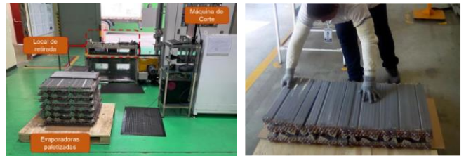
Fig. 6: Local de trabalho manual paletização de evaporadores.
